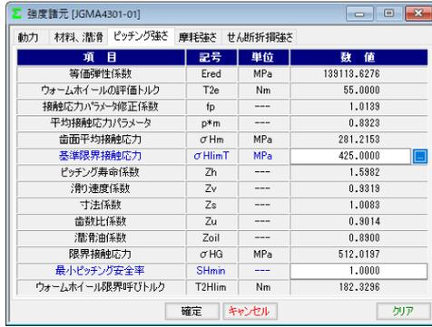
図 3.23 ピッチング強さの設定
